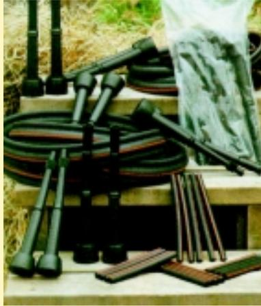
**Pezonera:** Conjunto que comprende una copa rígida con un tubo corto de pulsación y un manguito de ordeño. Al espacio anular existente entre la copa rígida y el manguito de ordeño se le denomina cámara de pulsación, la cual a través del tubo corto de pulsación se comunica con el colector. A su vez, el manguito de ordeño, por cuyo interior fluirá la leche, se comunica con el colector a través del tubo corto de leche.
